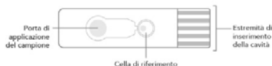
Figura 3. Vista del sensore raffigurante la porta di applicazione per il caricamento del campione
